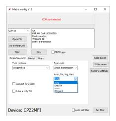
«**Avto»** – Выбирается **Wiegand** DATA\_0 и DATA\_1 подтянуты к +5B, **TM** на DATA\_0 если DATA\_1 замкнут на «землю» и **однократный TM** если DATA\_0 и DATA\_1 замкнуты.
