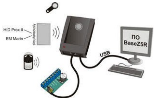
8. Схема подключения адаптера Z-2 (мод. E HTZ RF) к контроллеру и компьютеру
