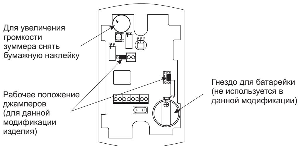
*Рис.1 Размещение элементов.*
