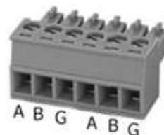
**iPORT1** - разъем для подключения к гальваноразвязанной линии №1 RS-485.
