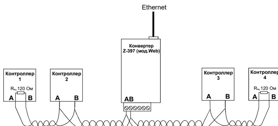
Пример схемы подключения конвертера в середине линии RS-485. Нагрузочное сопротивление подключать к Z-397 (mod. Web) не требуется. При большой длине линии связи необходимо объединить “земли” конвертера и контроллеров. Для этого можно использовать отдельный провод или пару проводов из кабеля, которым осуществлена прокладка линии RS-485.
