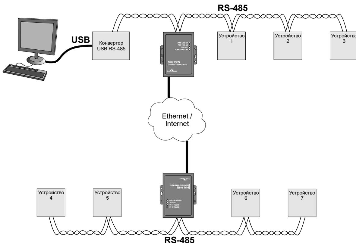
Пример конфигурации конвертеров для режима моста:
