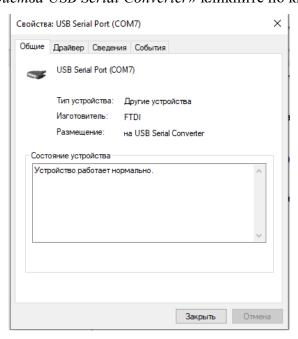
После установки «USB Serial Port» в разделе «Порты COM и LPT» в «Диспетчере устройств» появится «USB Serial port (COM...)».
