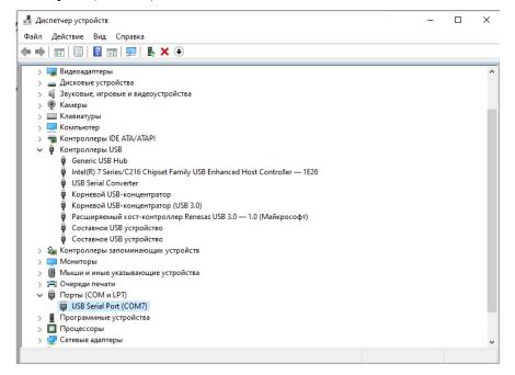
После проделанных операций драйверы установлены полностью и считыватель (адаптер, конвертер) появится в системе.
