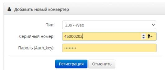
При нормальной работе, правильно настроенный конвертер должен подключиться автоматически, и также должны появиться в списке все подключенные к этому конвертеру контроллеры.
