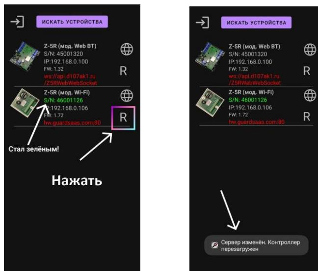
Снизу в приложении появится надпись «Сервер изменен. Контроллер (конвертер) перезагружен». Контроллер (конвертер) отключится от сервера СОМ. **Затем добавьте конвертер (IP-контроллер) на сервере RU!**
