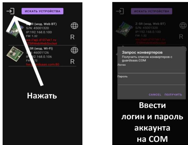
Выбрать нужный конвертер (IP-контроллер) из списка, нажав на него. Затем нажать на выбранном конвертере (IP-контроллере) кнопку «R».
